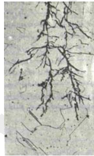
مقطع ترکهای تنش در فولاد زنگ نزن (500×)
